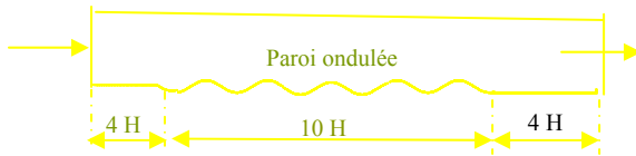
Figure 1 : Schéma et géométrie du canal ondulé
